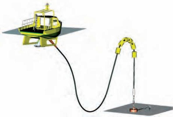
**Fig. 6 - Station de mesure multi-paramètres fond et surface mise en œuvre dans le cadre de PREVIMER en baie de Vilaine**
