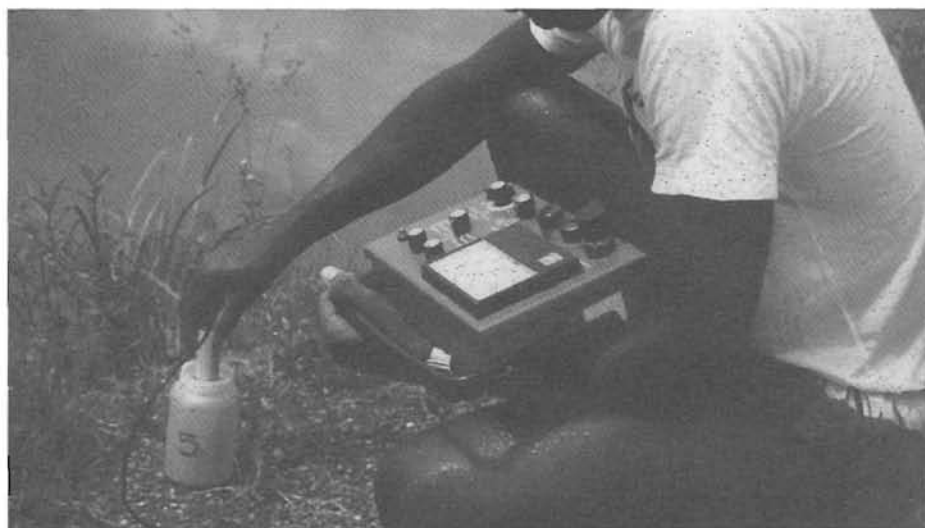
Figure 3.38 : Mesure de la teneur en oxygène dissous d'un échantillon d'eau de fond à l'aide d'un oxymètre électronique.
