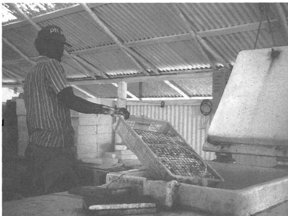
Figure 3.89 : Dispositif de congélation en saumure (SAOR, Guyane).
