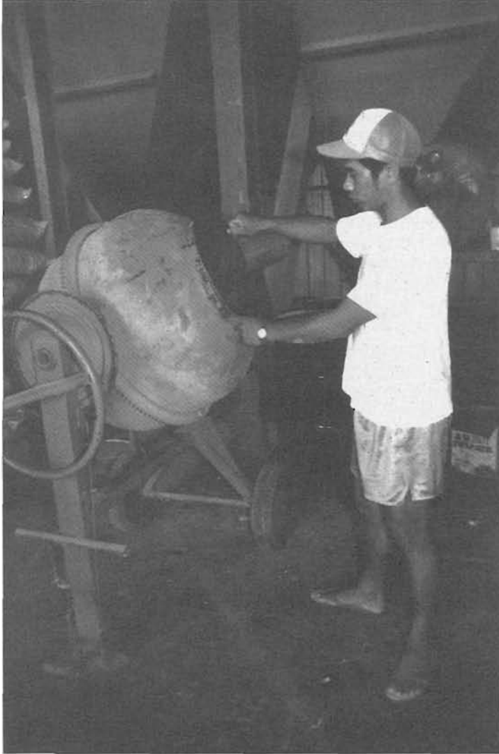
Figure 3.23 : Bétonnière utilisée pour l'enrobage du granulé.
