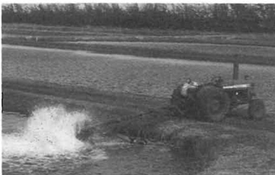
Figure 3.48 : Principaux types d'aérateurs : (a) aérateur à hélice (AIRE-O 2 ), (b) paddle wheel, (c) paddle wheel mobile sur prise de force de tracteur.
