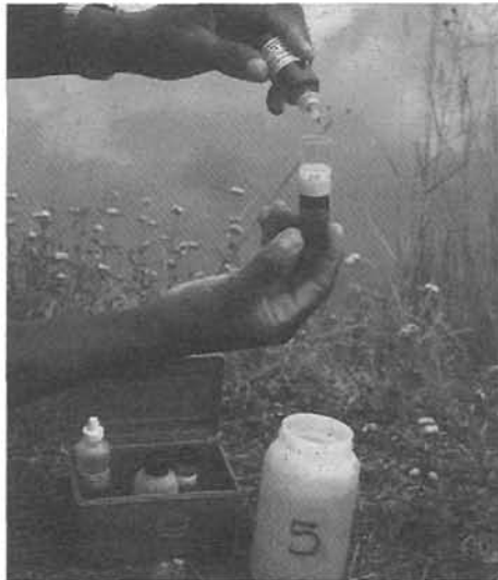
Figure 3.41 : Mesure par colorimétrie de la dureté-alcalinité.
