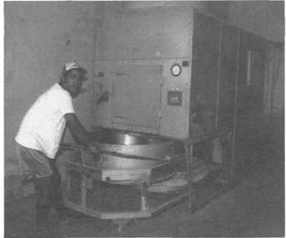
▲ Figure 3.21 : Séchoir à lit fluidisé pour granulés en sortie d'extrudeuse (Tahiti).
