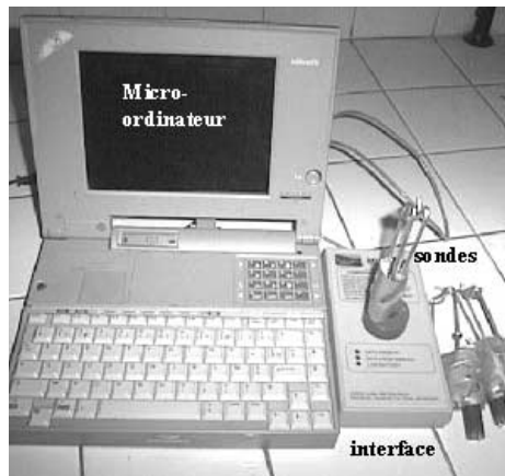
Figure 4 - Initialisation et transfert des données issues des capteurs pression-température.
