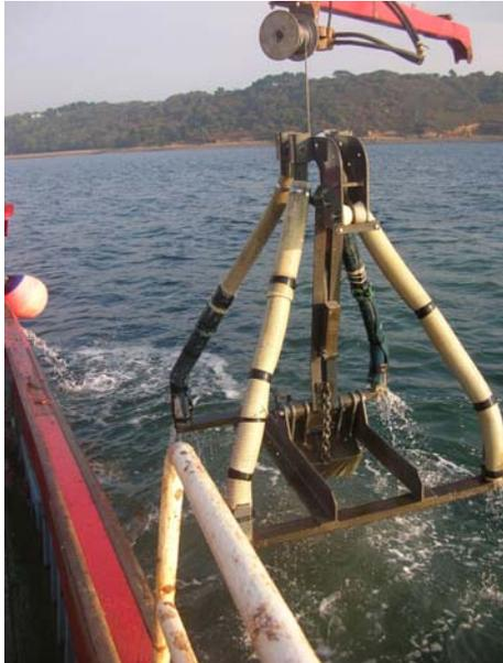
Figure 2 : La benne Hamon chargée de sédiments est remontée à bord.
