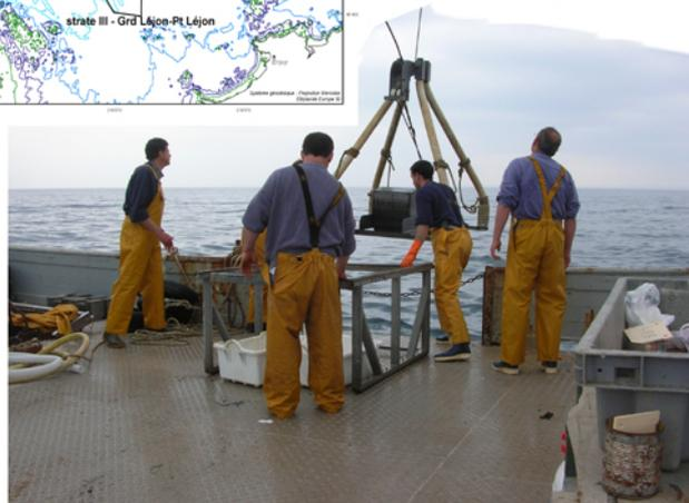
Prélèvement du sédiment à la benne Hamon
