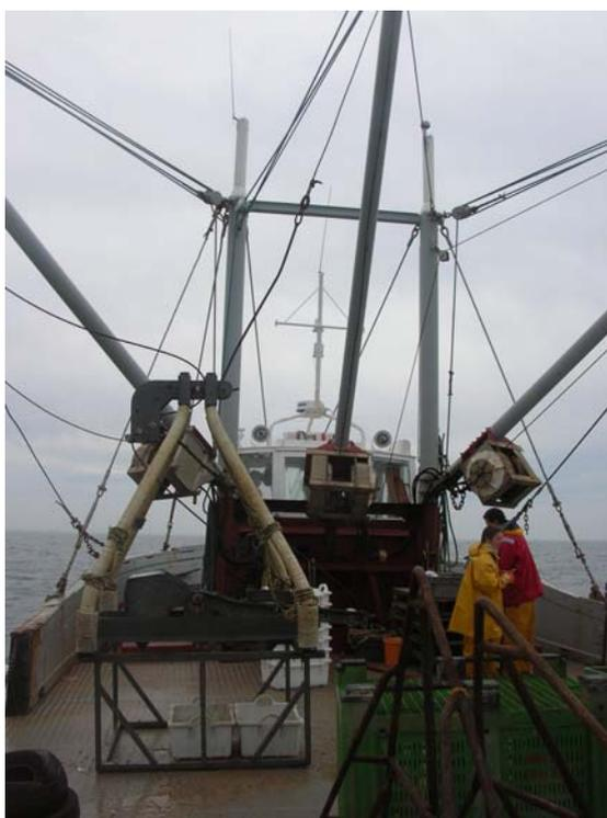
Figure 1 : Benne Hamon sur le pont du navire professionnel « Narval Bretagne ».
