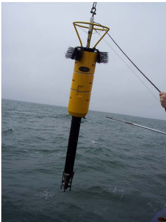
Figure 5 : Photo du VMP, les capteurs sont à l'extrémité en bas de l'instrument.
