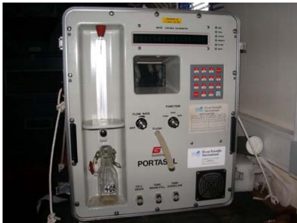
Figure 12 : Photo du salinomètre Portasal (sans la pompe).
