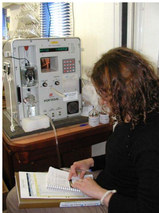
Figure 13 : Photo du salinomètre Portasal (avec la pompe).
