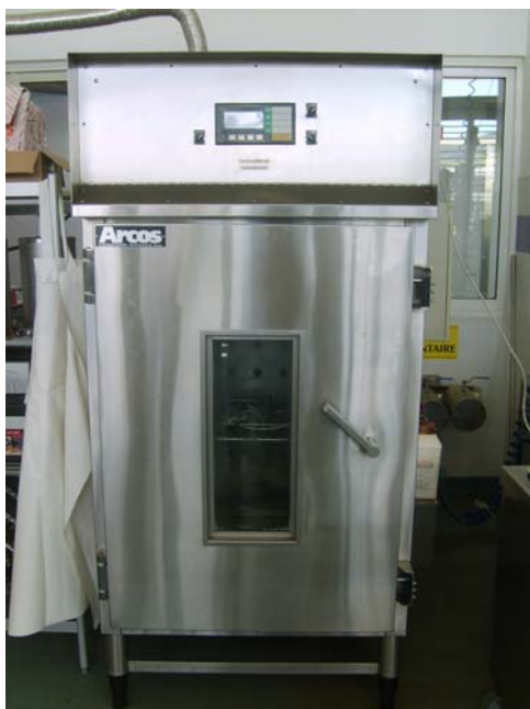
photo 7 : Cellule fumage ARCOS
