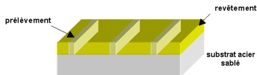
Figure 55 Revêtement adhésif-acier avec les 3 prélèvements pour la mesure de DSC
