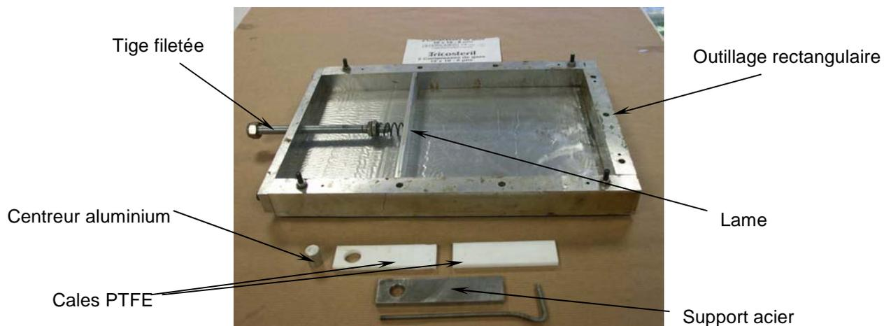
Figure 186 Cadre de mise en œuvre des assemblages Double Lap Shear
