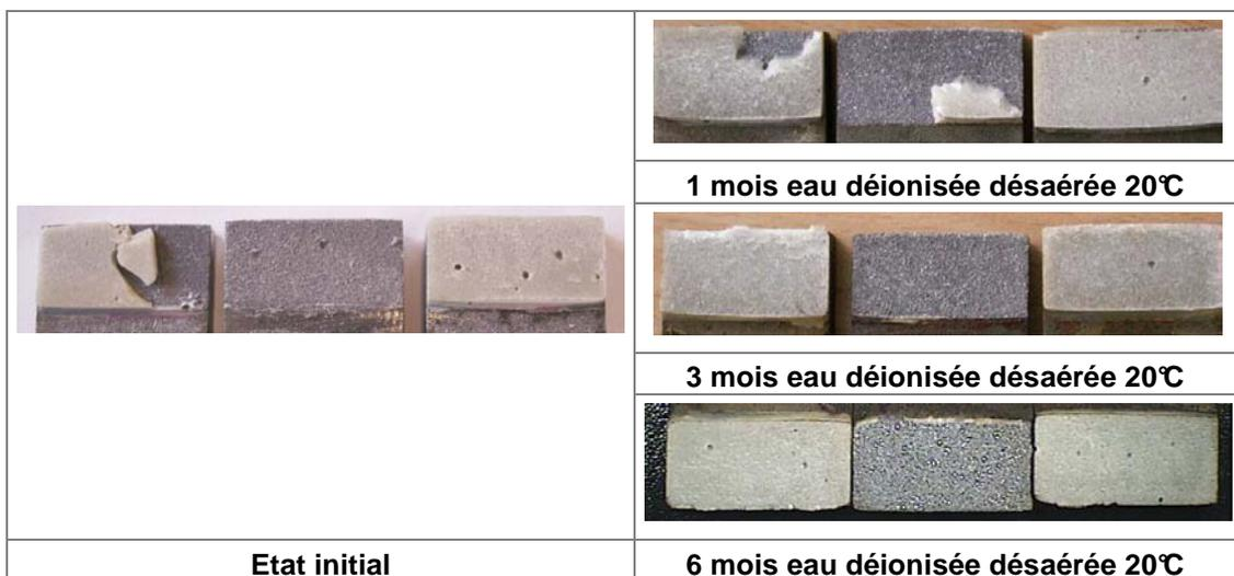
Figure 143 *Faciès de rupture des assemblages Double Lap Shear vieillis à 20°C en eau déionisée désaérée à 1,3 et 6 mois*
