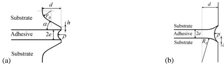
Figure 189 Géométries de l'extrémité de l'assemblage Arcan avec bec et de l'assemblage Arcan modifié avec chanfrein
