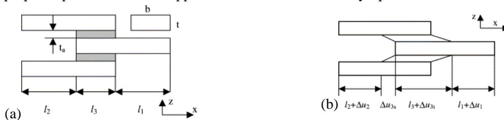
Figure 161 Schéma d'un assemblage DLS sous une sollicitation
