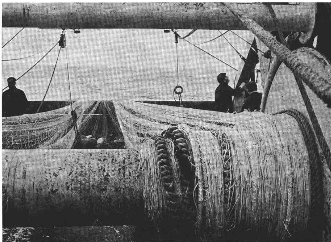
FIG. 9. — Virage d'un chalut pélagique sur le « Tridens » (photo Afdeling Technisch Onderzoek, Van de Directie van de Visserijen).
