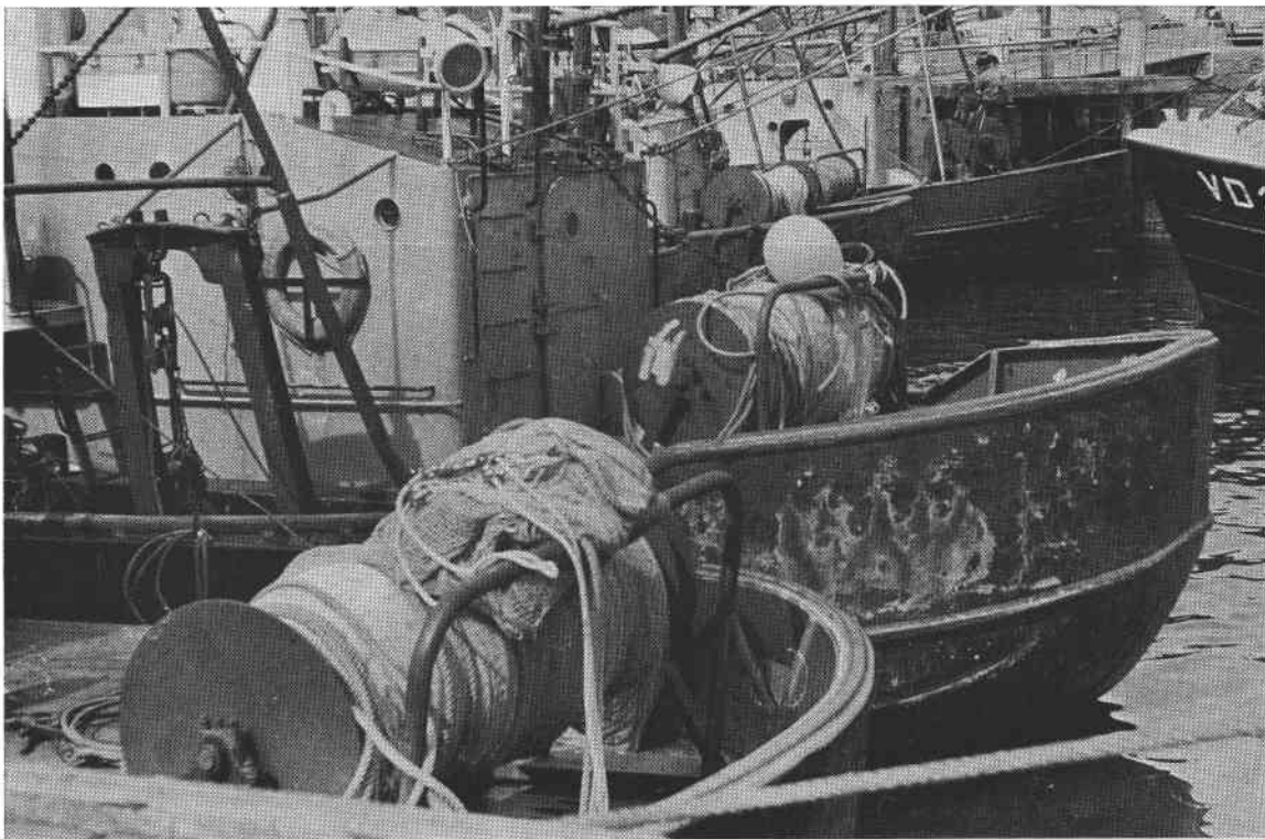
FIG. 1. — Tous les bateaux classiques d'environ 300 cv utilisent des tambours enrouleurs de chalut (photo ISTPM).
