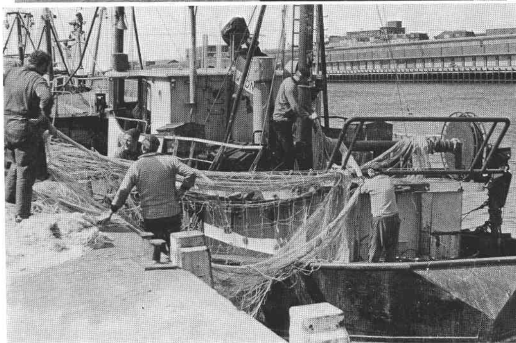
FIG. 3 et 4. — Tambour installé au-dessus du château arrière. On remarque le cadre en tube métallique qui sert de guide ainsi que l'arrière tronqué du bateau. Un chalut de dimension respectable et possédant des grandes mailles à l'entête, prend peu de place sur le tambour (photo ISTPM).
