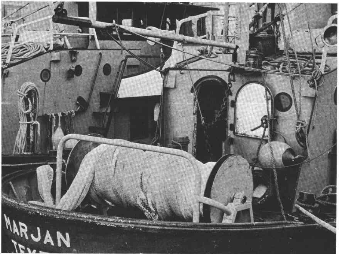
FIG. 2. — Détail de l'installation d'un tambour sur un bateau à pêche latérale (photo Afdeling Technisch Onderzoek, Van de Directie van de Visserijen).
