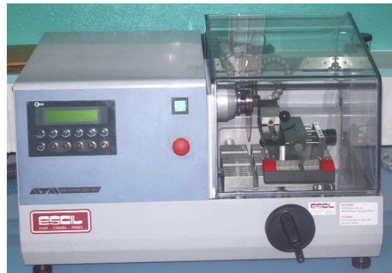
Figure 30 : Tronçonneuse Brillant 221 ® automatique d'Escil à vitesse variable (400 à 6000 tours/minute).
