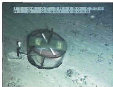
_imag005.tif Positionnement de l'enceinte de confinement par dessus l'épuisette
