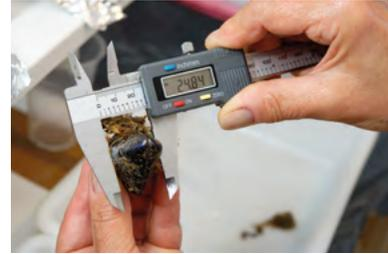
Le pied à coulisse est le principal instrument de mesure pour les mollusques bivalves et gastéropodes, ainsi que pour les crustacés. Cet instrument se présente selon trois types : mécanique, à affichage numérique et à acquisition automatique. On privilégiera l'usage des pieds à coulisse numériques ou à acquisition automatique.
