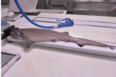
C'est le principal instrument de mesure pour tous les poissons et céphalopodes. Cet outil est constitué d'une planche sur laquelle est apposée une règle (graduation en mm,  $\frac{1}{2}$  cm ou cm). L'une des extrémités (origine des mesures) est munie d'une butée qui permet de facilement positionner l'individu au moment de la mensuration (voir photo). Pour les poissons vivants, privilégiez une règle en V ou en gouttière, qui permet de stabiliser l'individu, comme dans le cas des salmonidés.
