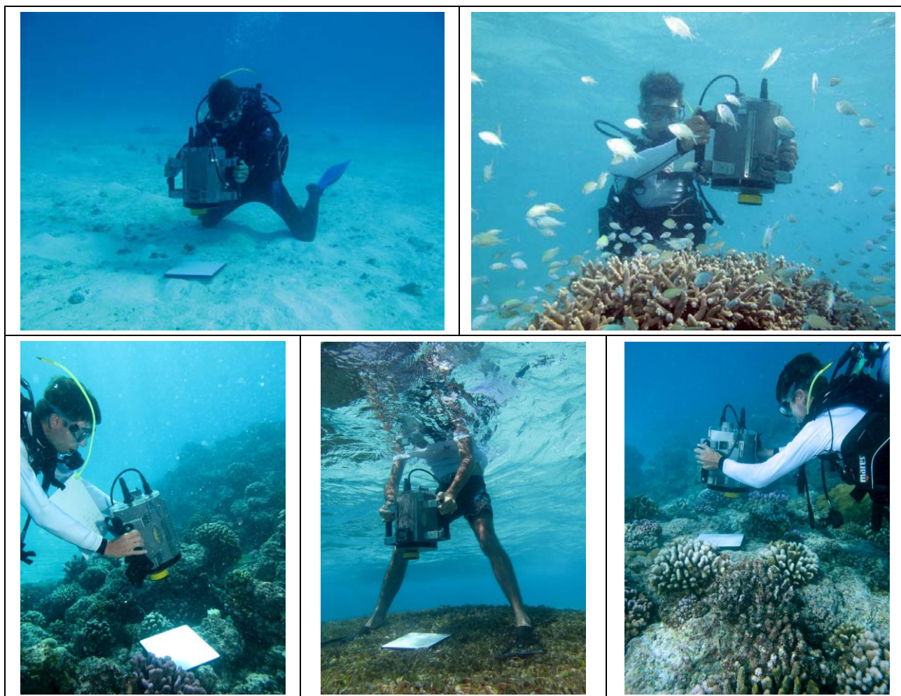
Figure 6. Exemples de mesures réalisées à l'aide du spectroradiomètre. De gauche à droite, en haut : calibration de l'appareil à l'aide du Spectralon (surface de référence revoyant 99% de l'énergie lumineuse incidente) avant mesures sur le fond sableux (Profondeur : 10 m) et mesures sur un acropore branchu par 2 m de fond. En bas, mesures sur acropores digités et pocillopores par 3,5 m de fond, et dans un herbier de Thalassodendron ciliatum par 1,5 m de profondeur devant l'île du Lys (Glorieuses).
