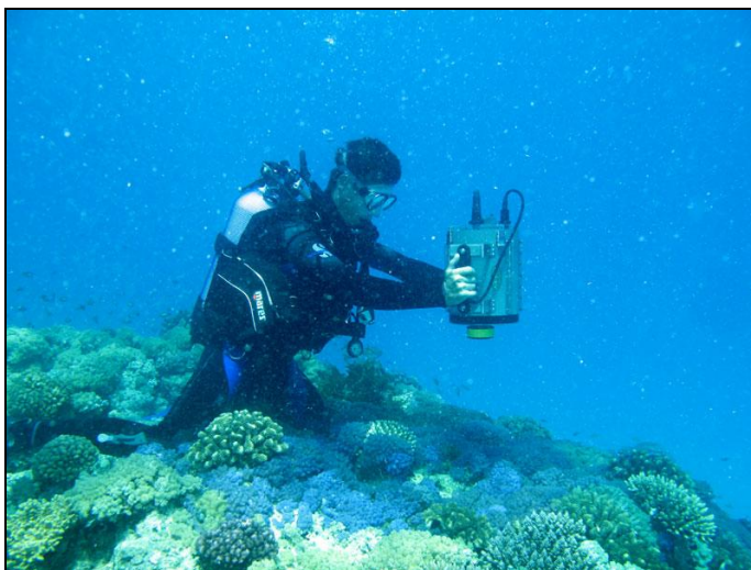
Figure 7. Plongeur réalisant les mesures sur diverses cibles en maintenant le spectroradiomètre immobile à une distance d'environ 40 cm avec le fond.
