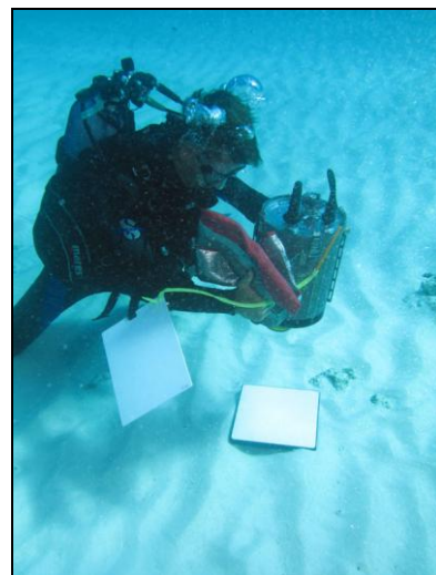
Figure 7. Plongeur réalisant les mesures sur diverses cibles en maintenant le spectroradiomètre immobile à une distance d'environ 40 cm avec le fond.
