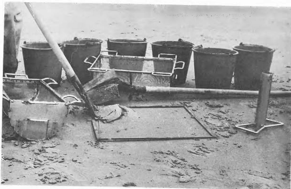
Fig. 138 : Matériel nécessaire à chaque prélèvement
