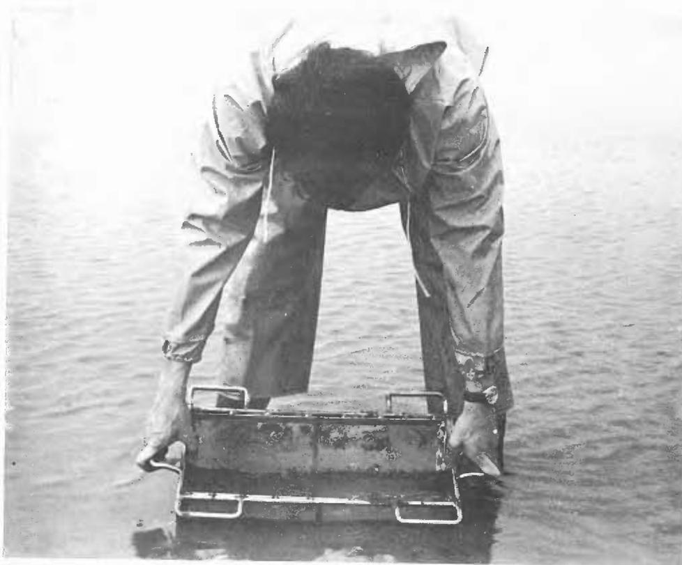
Fig. 140 : Tamisage du sédiment dans l'eau de mer
