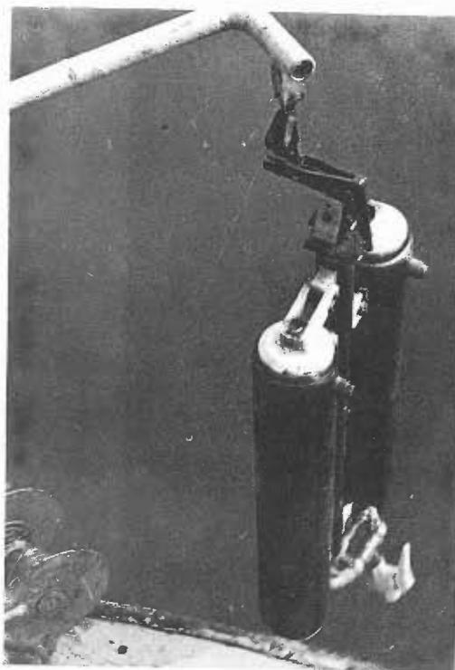
Fig. : 26 : BOUTEILLE A CLAPETS MECABOLIER (type NANSEN)
