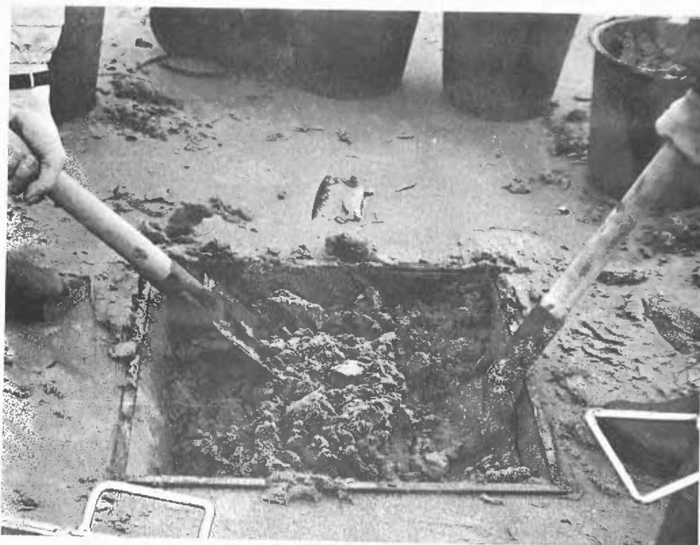
Fig. 139 : Prélèvement de sable effectué sur une surface de  $1/4 \text{ m}^2$ , jusqu'à 0,30 m de profondeur
