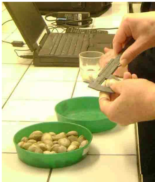
Figure 25 : Mesures des coques d'un lot au pied à coulisse.
