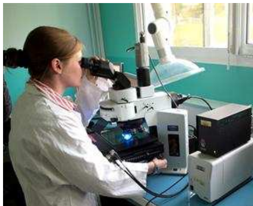
Figure 32 : observation d'un échantillon sous microscopie à épifluorescence.
