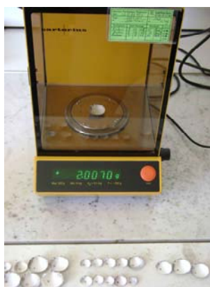
Figure 16 : Pesée de la valve à l'aide d'une balance de précision.
