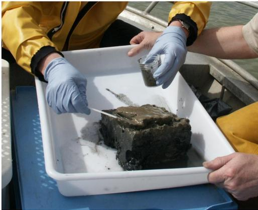
**Figure 5** : Prélèvement du premier centimètre superficiel d'une carotte obtenue à l'aide d'une benne de type Eckman sur embarcation légère.
