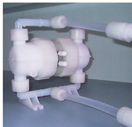
**Figure 3** : Pompe à piston en téflon (Asti, France).
