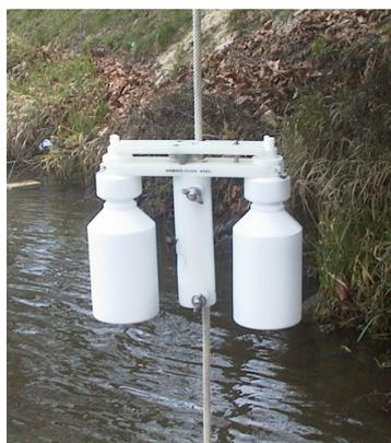
**Figure 2** : Bouteille à prélèvement Merkos (Hydro-bios, Allemagne).
