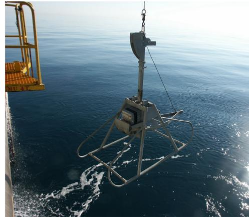
**Figure 6** : Mise à l'eau d'un carottier-boîte de type Micro-Reineck sur navire hauturier.
