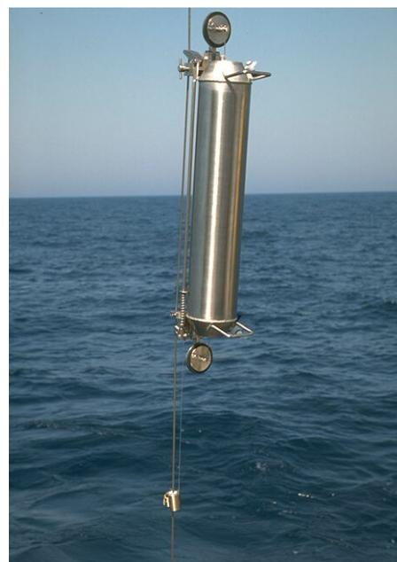
Figure 4 : Bouteille de prélèvement en acier inoxydable.
