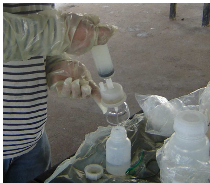
Figure 5 – Filtration d'eau de mer avec seringue en polyéthylène et cartouche SARTOBRAN-300
