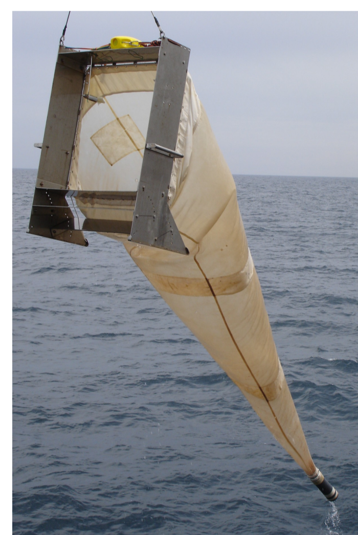
Figure 2 : Filet Carré d'un mètre carré d'ouverture et de 315 µm de vide de maille
