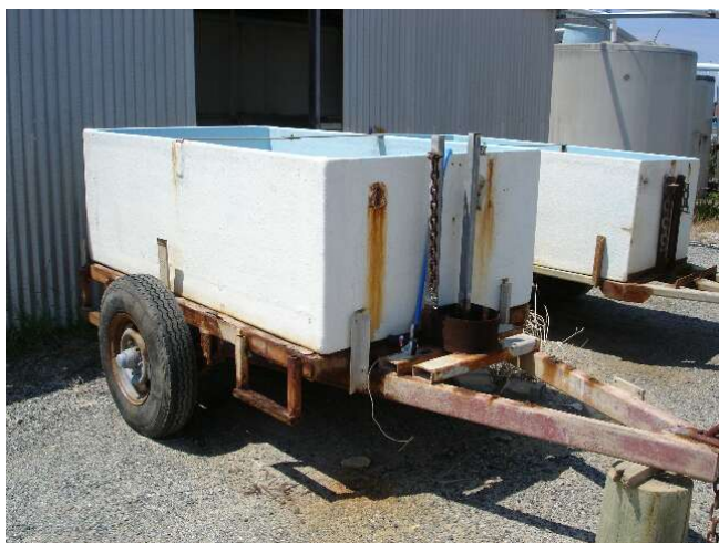
Figure x : les remorques qui transportent les crevettes sous oxygène entre le bassin et l'unité de conditionnement
