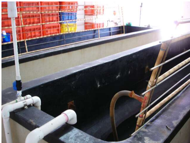
Figure x : les deux bacs de refroidissement, on remarquera la rampe d'aération, relevée pour nettoyer le bassin en période de non-fonctionnement. Au fond les caisses ajourées utilisées pour le transport.
