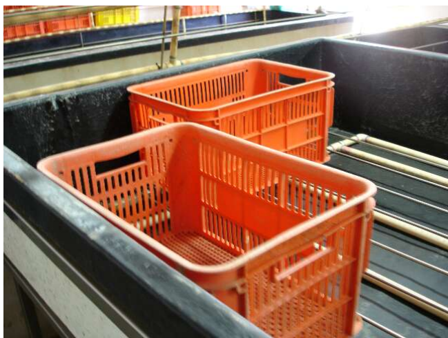
Figure x : le bac-table de tri qui permet de trier en eau aérée les crevettes par classe de taille
