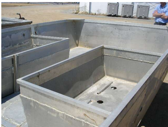
Figure x : les bateaux-viviers en métal inoxydable comportent deux bacs viviers latéraux, qui communiquent par le fond avec l'eau du bassin d'élevage.
