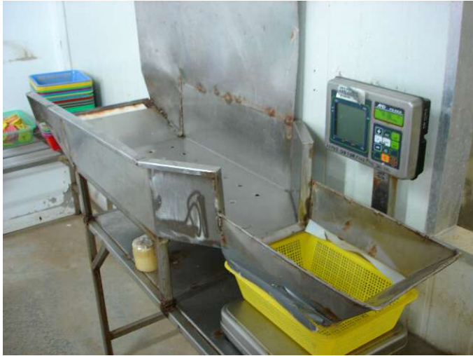
Figure x : la balance permettant de peser au plus près un lot de même classe à 1 kg
