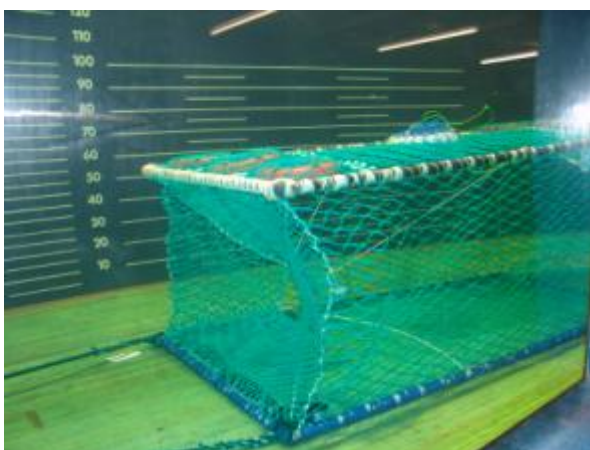
Photo 9 : Nasse parallélépipédique pliante (vitesse de 0,75 nœud en bassin)
