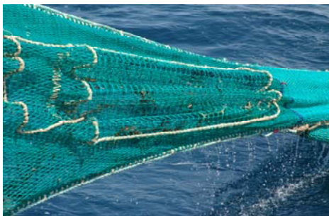
Photo 7 : Panneau de mailles carrées « à merlu » dans le dessus du gorget
