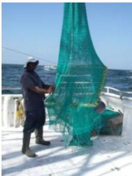
Photo 3 : Montage du kit grille Nordmore à bord du chalutier
