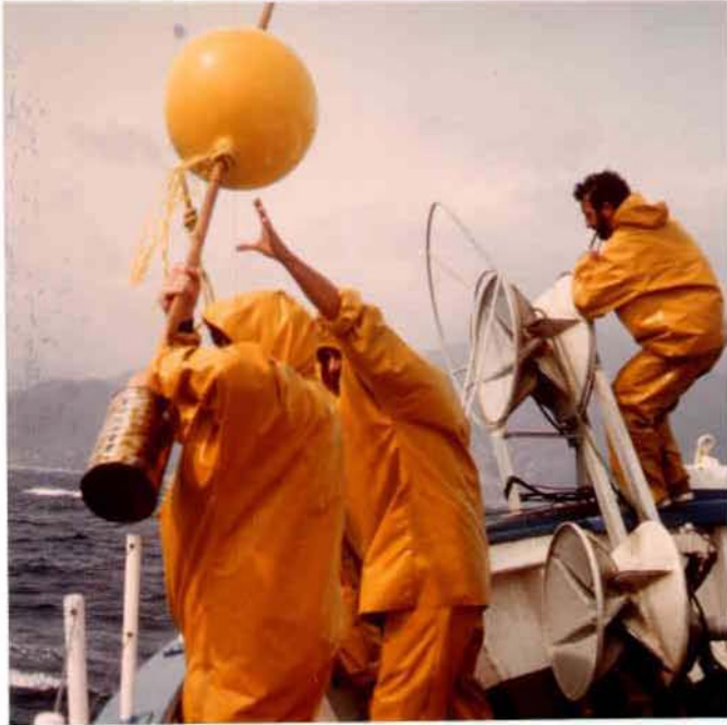
Ph. 1. Ich thys. Roue remonte-filet ; relevage de la bouée
