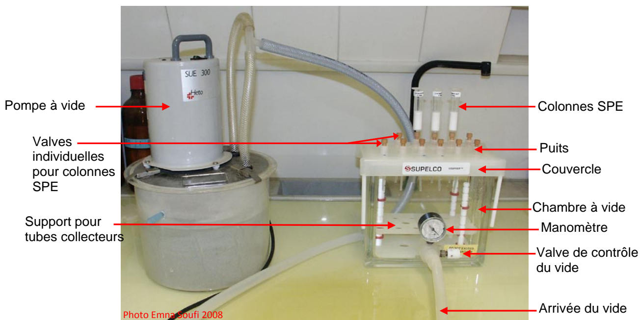
Figure II.14: Montage effectué au labo pour l'extraction solide-liquide simultanée des échantillons
