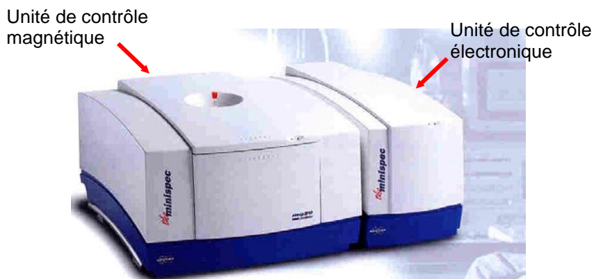
Figure II.26 : Appareil RMN Minispec PC 120 utilisé
