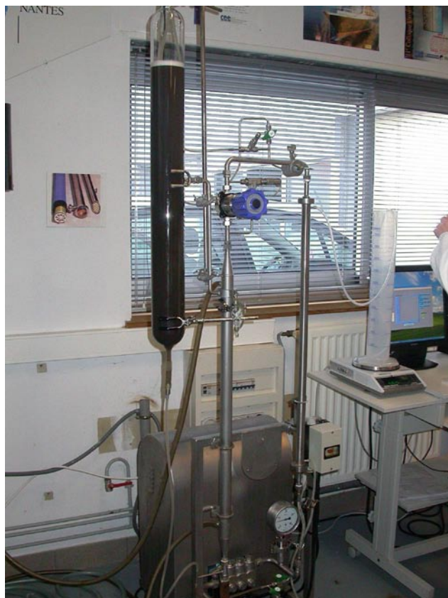
Figure II.19: Photo et schéma de principe du pilote de filtration UF/NF Microlab 40 (VMA)
