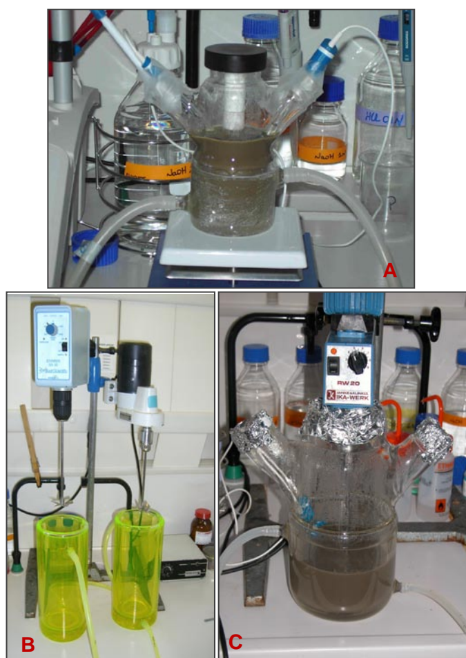
Figure I.30: Différents modèles de bioréacteurs enzymatiques utilisés à échelle de laboratoire. A : Réacteur 800 ml. B et C : Réacteurs 2 L.
