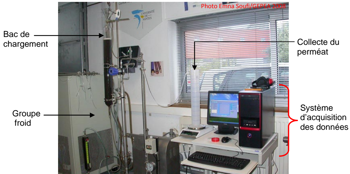
Figure II.20: Installation du pilote et système d'acquisition des données
