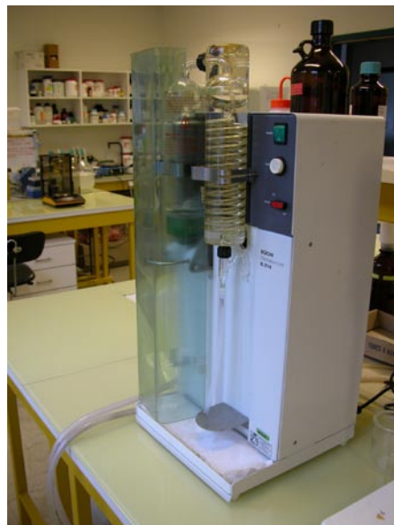
Figure II.21: Unité de distillation utilisée au laboratoire pour le dosage de l'azote total
