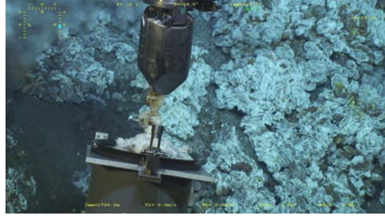
Un module de colonisation microbien a aussi été récupéré. Photo Victor.
