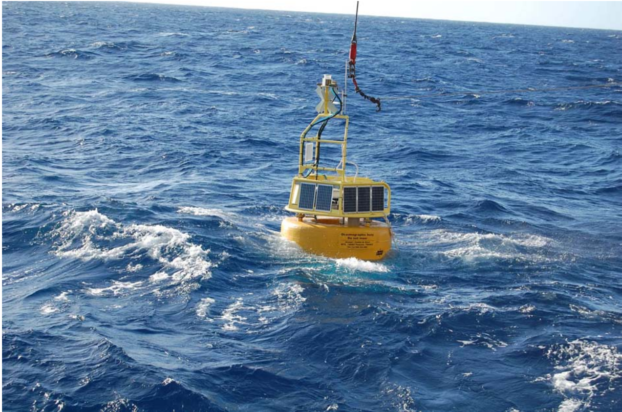
La bouée BOREL a été déployée avec succès au dessus du champ hydrothermal Lucky Strike. Photo Jozée Sarrazin
