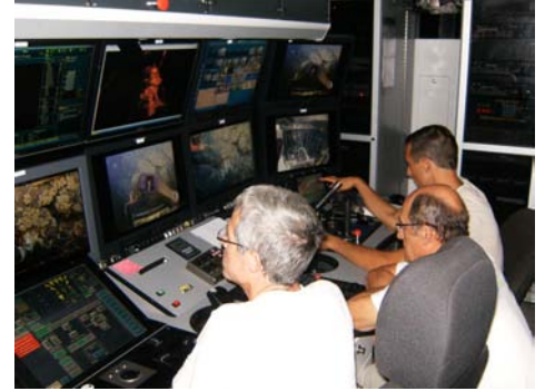
Victor6000 est piloté de la surface depuis un conteneur spécialement aménagé. Photo Jozée Sarrazin.
