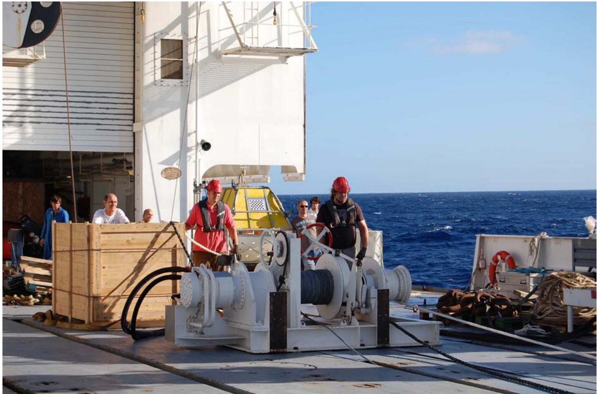
Filage de la ligne de 1686 m qui relie la bouée à son lest. Photo Jozée Sarrazin
