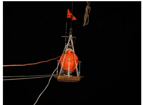
Mouillage d'un OBS. Photo Javier Escartin.
