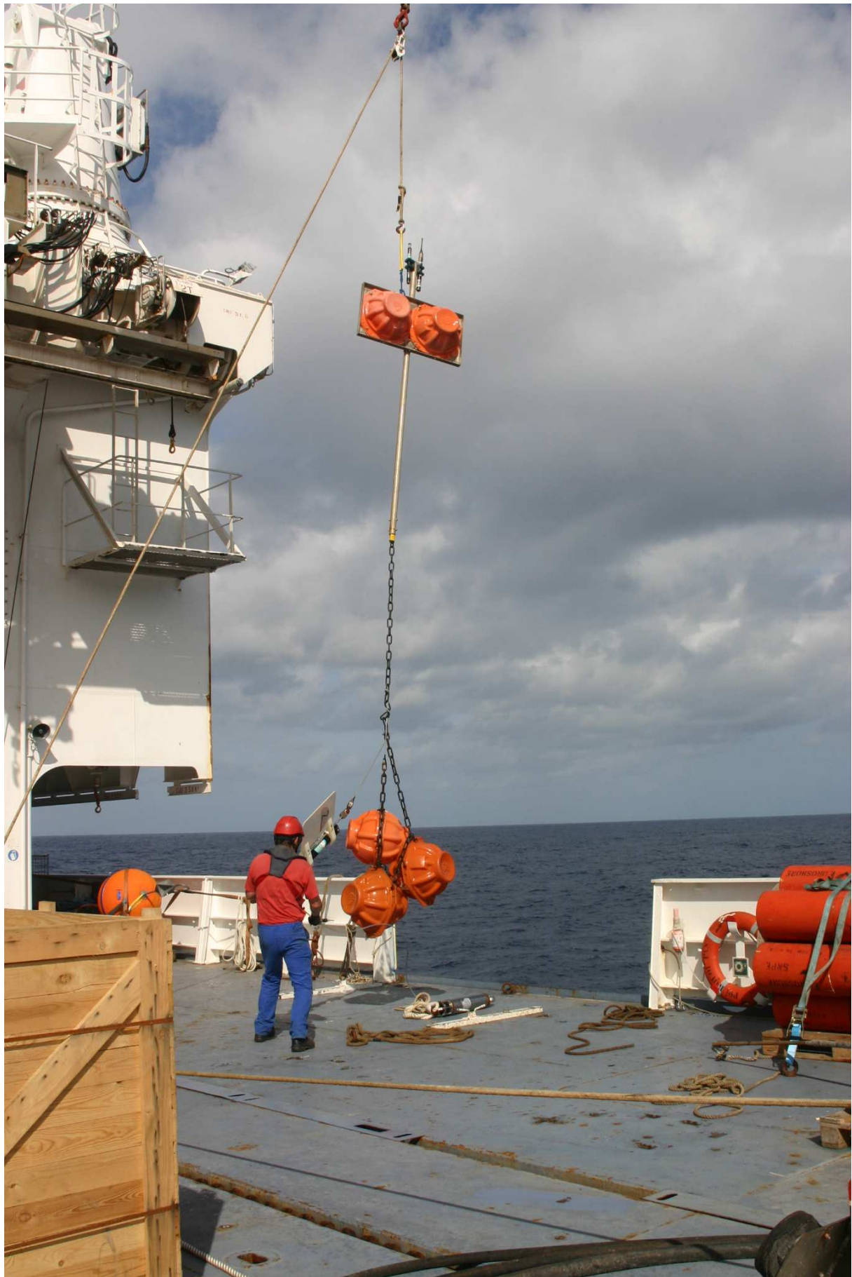
Récupération de la flottabilité d'un courantomètre. Photo Jérôme Blandin.
