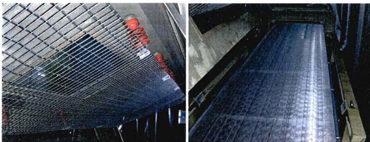
a / b / Figure 101 – a / électrode de décharge initiale, b/ électrode de collecte où circule le produit à traiter
