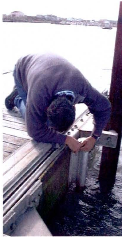
Photo 2 : Mise en place de la sonde de mesure salinité température Ysi dans son conteneur de protection sur le ponton flottant de la base nautique des Fontaines de Lupin.
