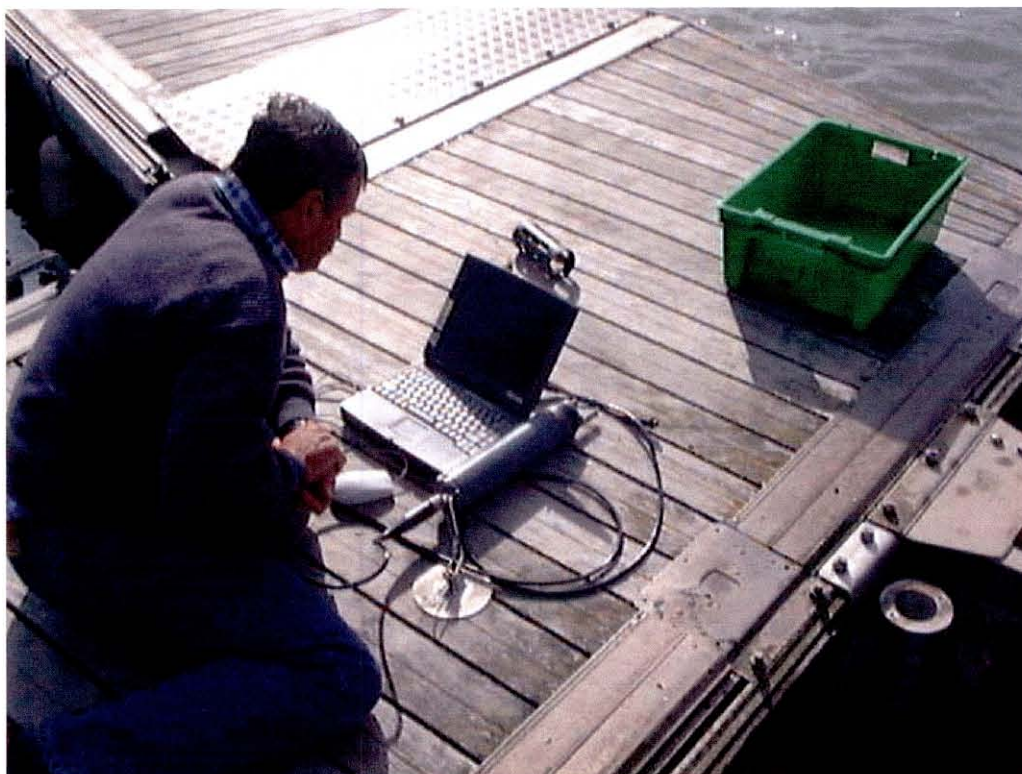
Photo 3 : Extraction des données enregistrées de la sonde de mesure par l'intermédiaire d'un câble coaxial de liaison et d'un micro-ordinateur portable, sur le site de mesure des Fontaines de Lupin.
