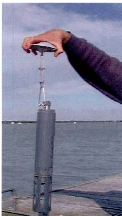
Photo 1 : présentation de la sonde d'acquisition multiparamétriques Isy 6920 avant sa mise en place dans son conteneur de protection.
