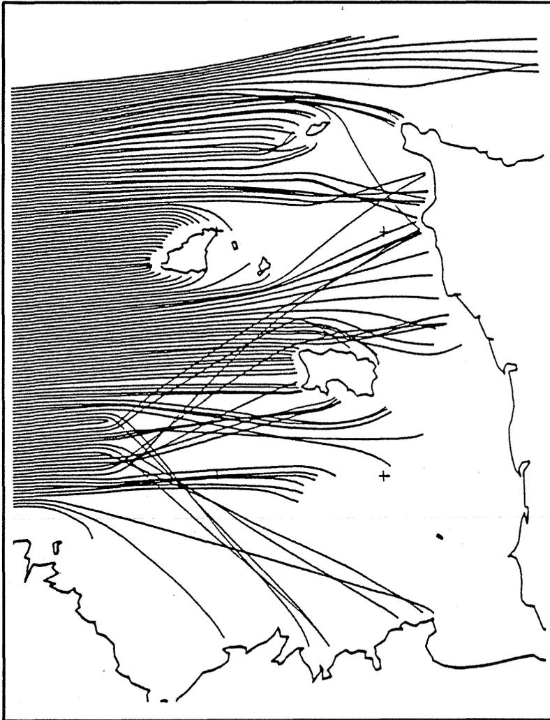
Figure 8 : Epure de réfraction calculée dans le Golfe normano-breton.
