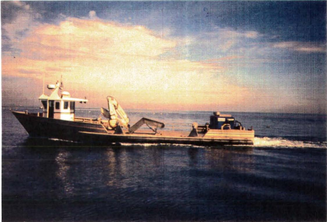
Photo 13 - Barges mytilicoles utilisées pour la mise à l'eau et le relevage des conteneurs.
