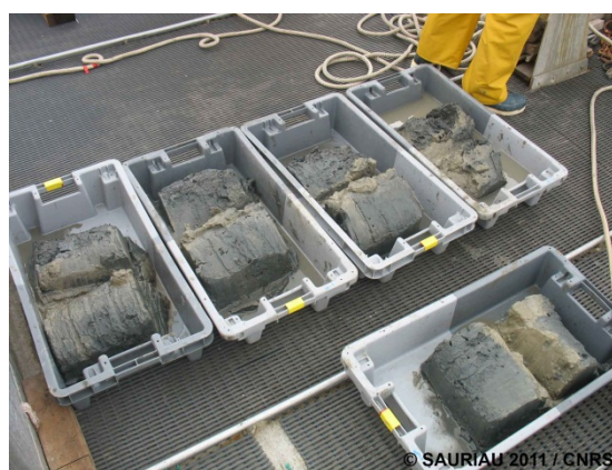
Figure 4 : Exemple de cinq prélèvements réalisés à la benne Van Veen sur la station Boyardville
