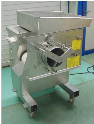
Figure 29 :Séparatrice mécanique Baader
