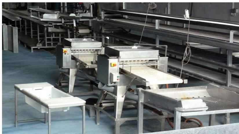
Figure 31 : Ligne de filetage manuelle (1)
