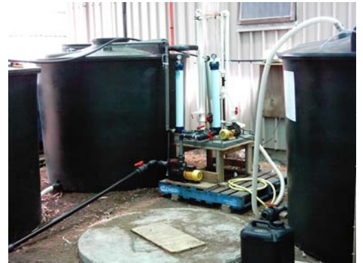
Système centralisé de traitement de l'eau de mer avec filtre de 100 microns, filtre au charbon actif et écumeur
