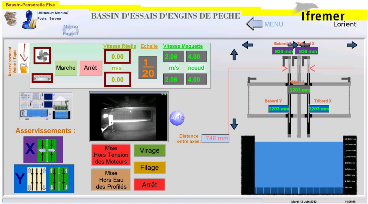
Figure 34 : Ecran de contrôle-commande de la supervision du Bassin d'Essais
