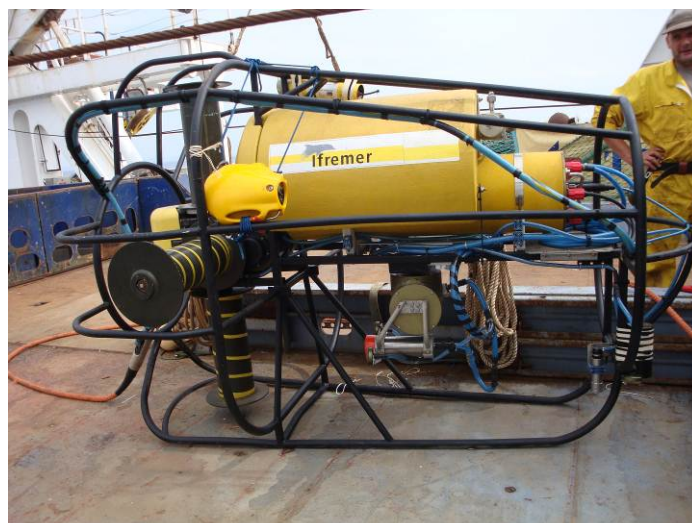
Figure 28 : Treuil et engin équipé des nouveaux capteurs
