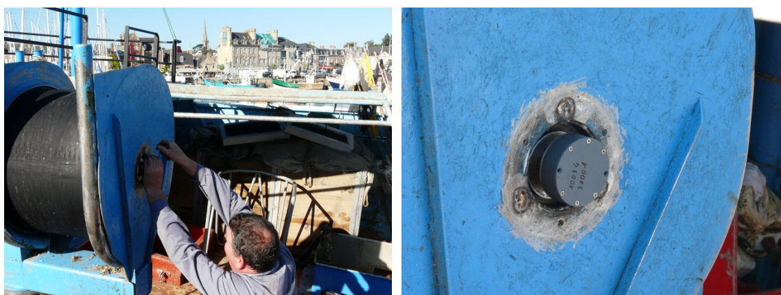
Figure 15 Dernière génération du compte-tour, installée sur un vire-filet.
