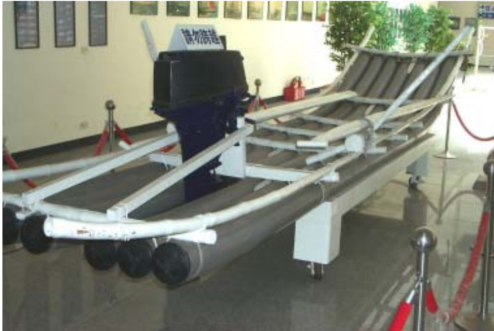
Figure 1: Sampan de marquage construit à partir de tuyaux de PVC de Ø de 15 mm
