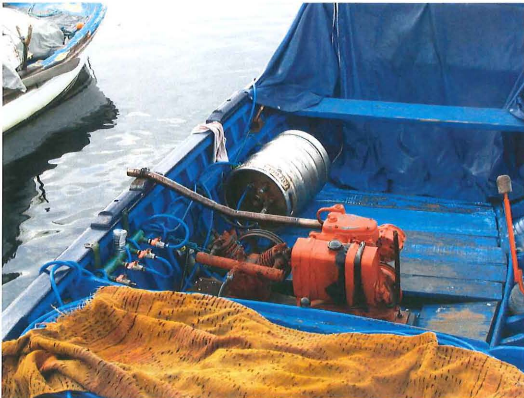
Photo 3 : Système de compression d'air pour la pêche à la palourde en plongée.
