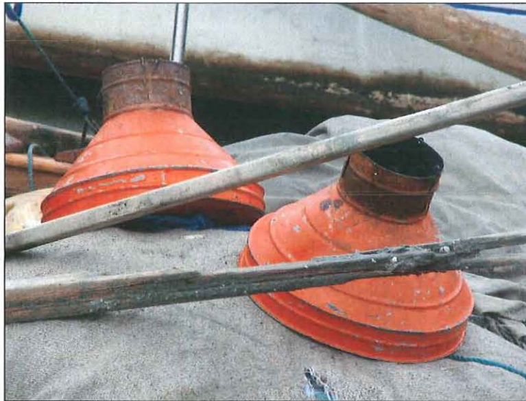
Photo 2 : Marques lumineuses de nuit : bornage des filets aux extrémités. Alimentation au gazoil.
