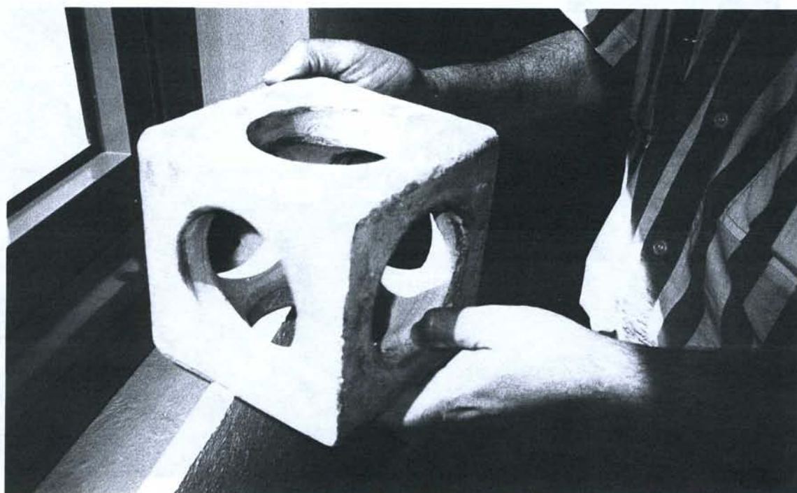
Photo 4 : Modèle réduit du petit module-type de récif artificiel utilisé au Portugal
