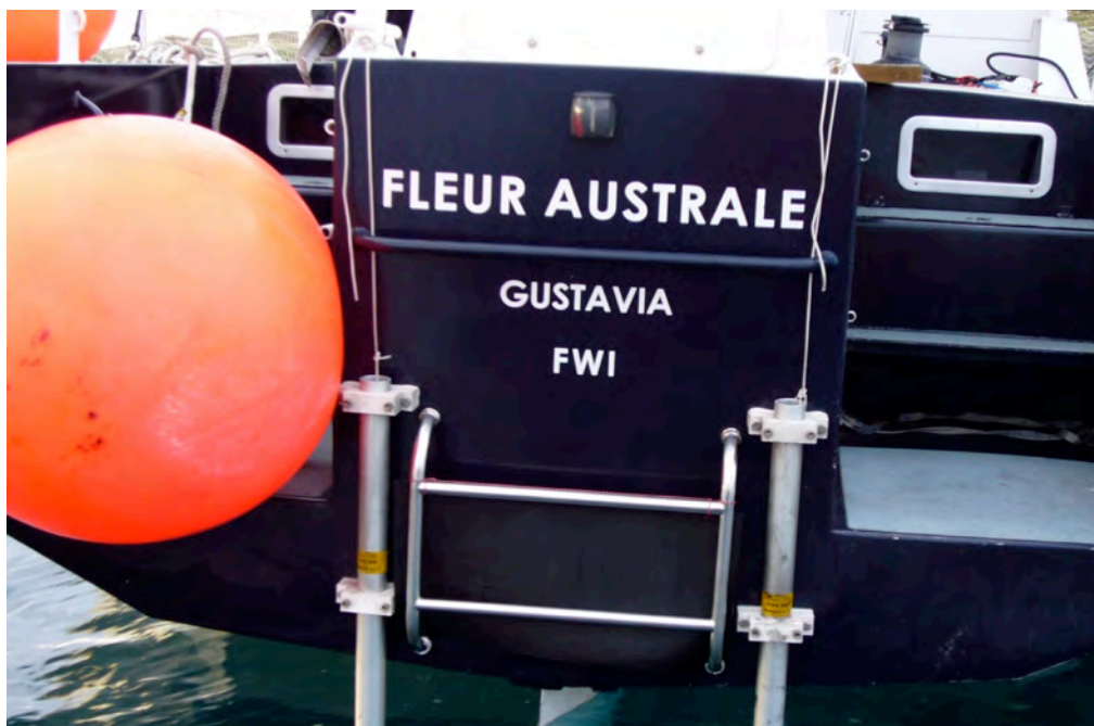
Figure 3 : Les sondes placées sur le tableau arrière, prêtes pour l'acquisition (© P. Poupon)
