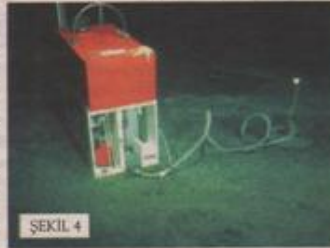
Deniz tabanında akışkan miktardaki değişimleri ölçen ve zaman serisi örnekleme yapan akışkanmetre-ozmometre (flowmeter-Osmometer). Bu sistem M. Trycan tarafından Scripps Oşinografi Enstitüsünde (ABD) geliştirilmiştir.
