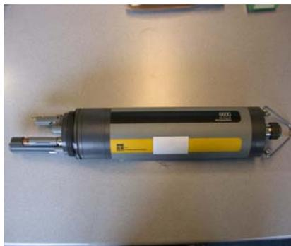
(Figure n°1 : sonde YSI 6600)
