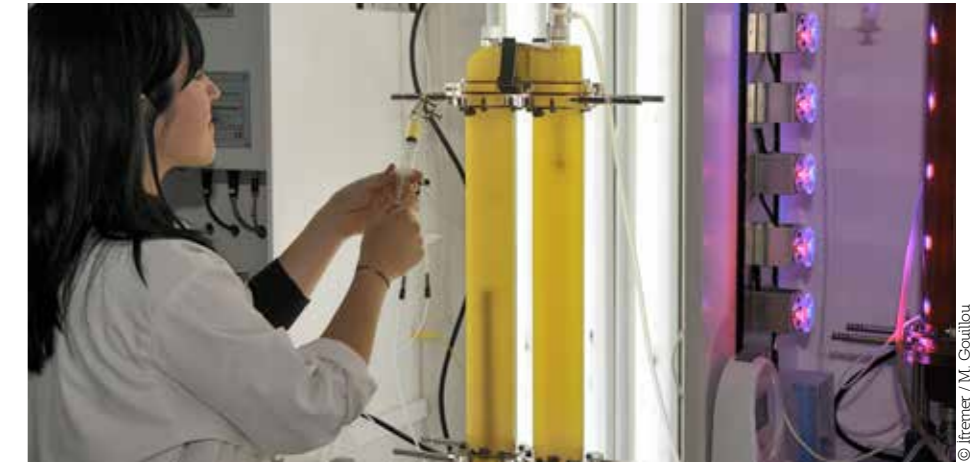
Prélèvement de microalgues dans un photobioréacteur, Laboratoire de Physiologie et Biotechnologie des Algues au Centre Ifremer de Nantes.
