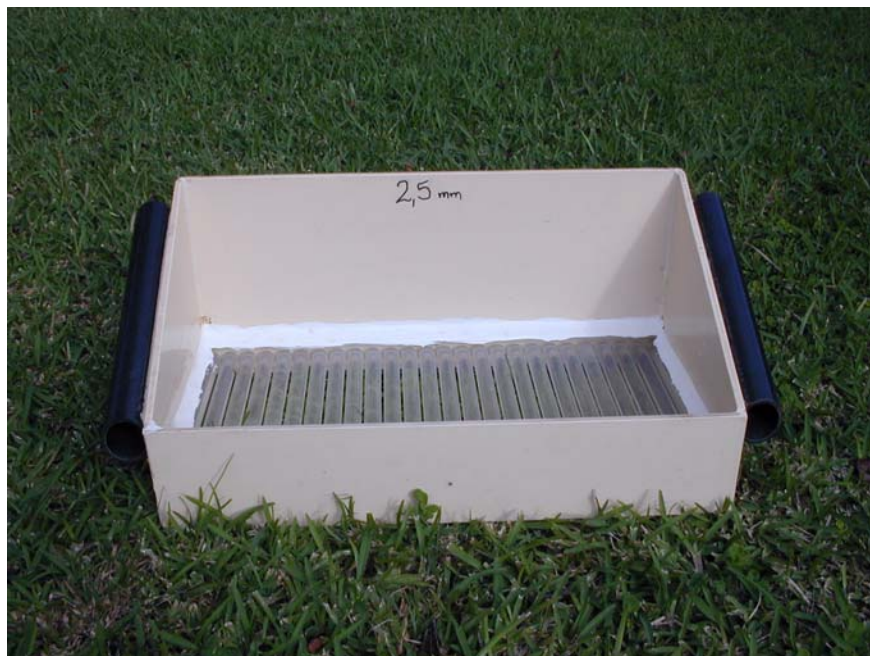
Photo 3 : Trieur à barreaux d'écartement nominal de 2.5mm
