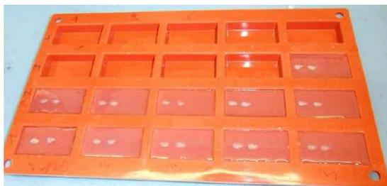
Figure 11 : Exemple d'inclusion individuelle pour une coupe transversale de l'otolithe *sagitta* et *lapillus*.
