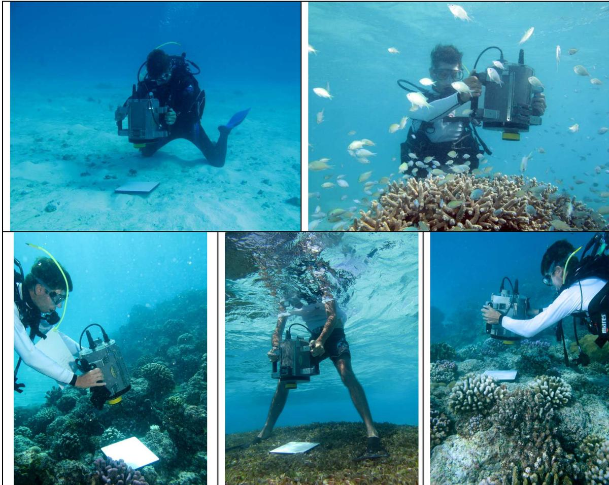
Figure 7. Exemples de mesures réalisées à l'aide du spectroradiomètre. De gauche à droite, en haut : calibration de l'appareil à l'aide du Spectralon (surface de référence revoyant 99% de l'énergie lumineuse incidente) avant mesures sur le fond sableux (Profondeur : 10 m), mesures sur un acropore branchu par 2 m de fond. En bas, mesures sur acropores digités par 3,5 m de fond, et dans un herbier de *Thalassodendron ciliatum* devant l'île du Lys (1,5 m de profondeur).
