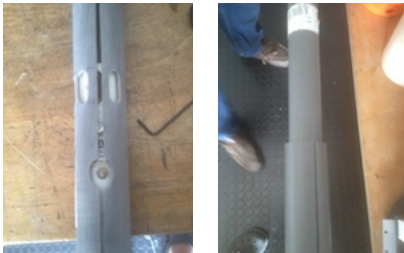
Figure 2: Fixation de la sonde NKE-STPS dans son support sur OLMIX
