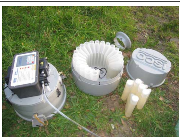
Figure 7 : Photo du Préleveur automatique ISCO 3700 en sortie de la station de lagunage
