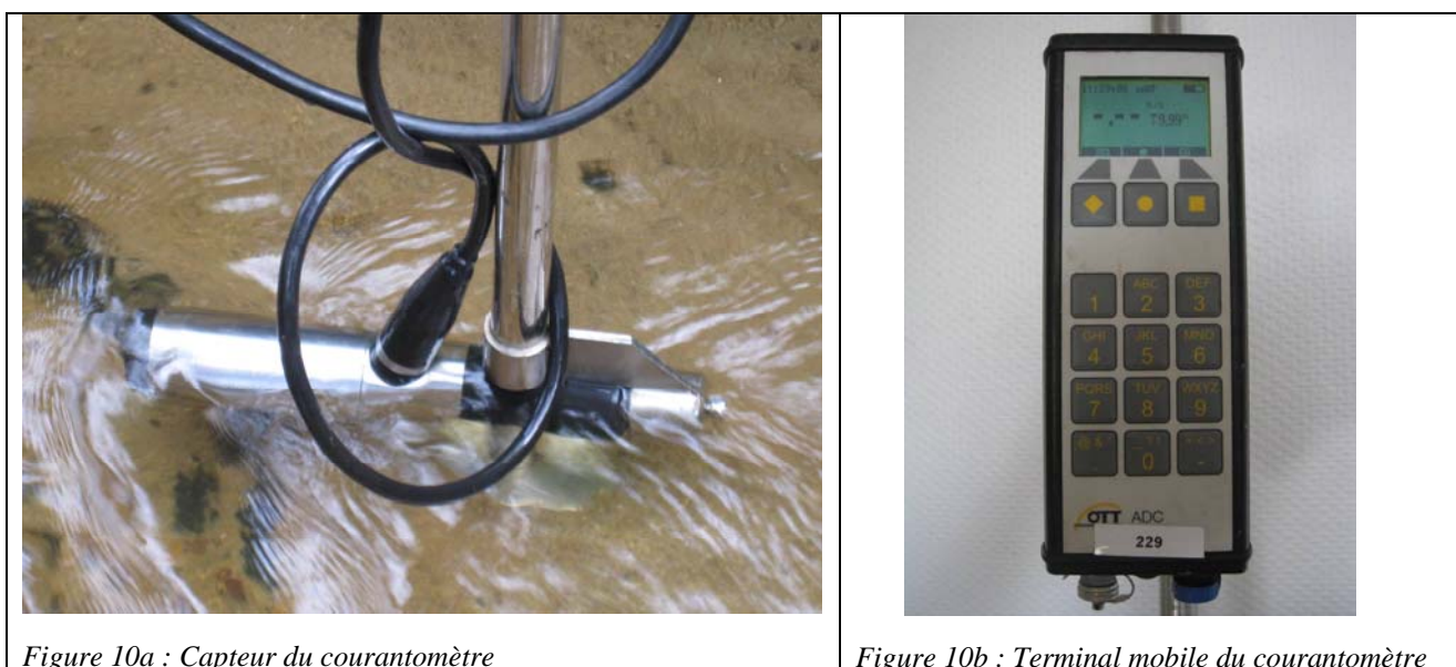
Figure 10 : Photos du courantomètre OTT ADC
