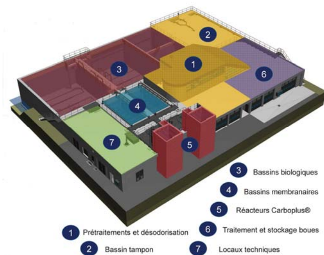
Figure 8 : Schéma de la station de traitement des eaux usées de Kerran (d'après document Stereau et Cabinet Bourgois)
