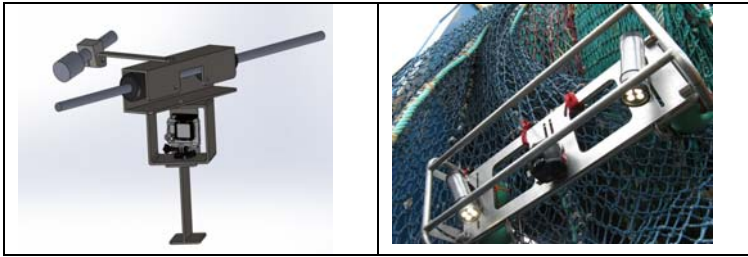
Photo 3: Exemples de systèmes vidéo légers et “bas cout” développés en interne
