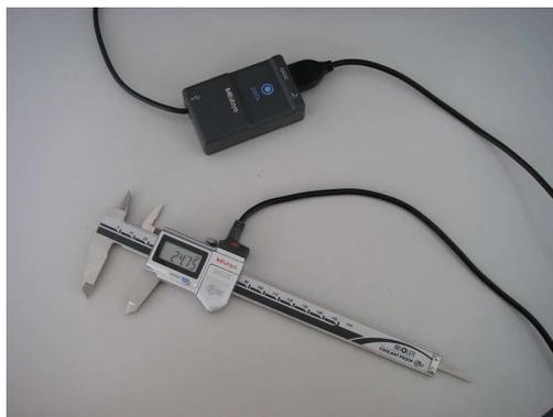
**Figure 4 :** Pied à coulisse relié à l'ordinateur via « l'input tool »
