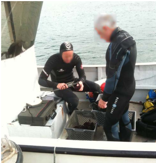
Figure 1 : mesure des oursins à bord du navire (pied à coulisse relié à une tablette PC)
