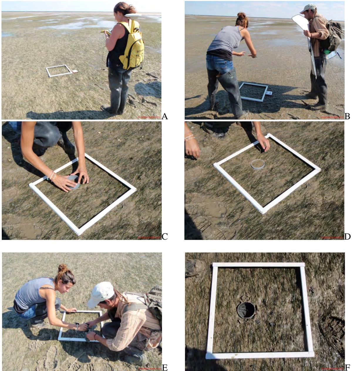
**Figure 12 :** Illustrations du positionnement par DGPS Trimble GeoXT (A), de la prise de photo d'un quadrat avec utilisation d'un pare-soleil (B) et des prélèvements granulométriques (C à F) comme réalisé depuis 2011. Photo C. Curty et P. Cajeri CNRS ©.
