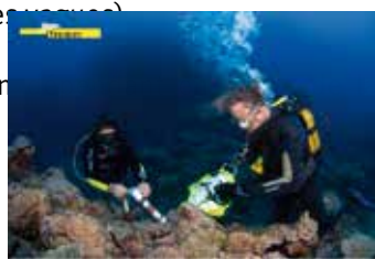
Figure 9 : Pose de capteurs de température et de pression (source : Les Antipodistes).
