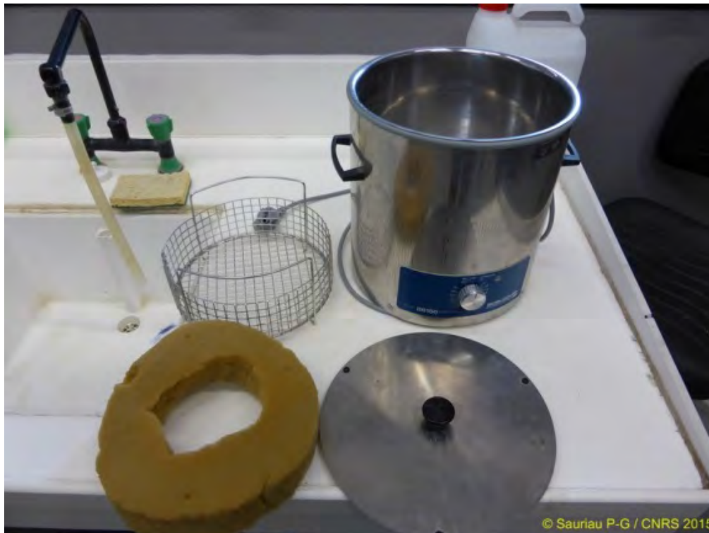
Figure 9 : Bain à ultrasons (A) avec détails du porte tamis et de la collerette en mousse (B) pour maintenir un bol à sédiment. Photo P.-G. Sauriau CNRS ©
