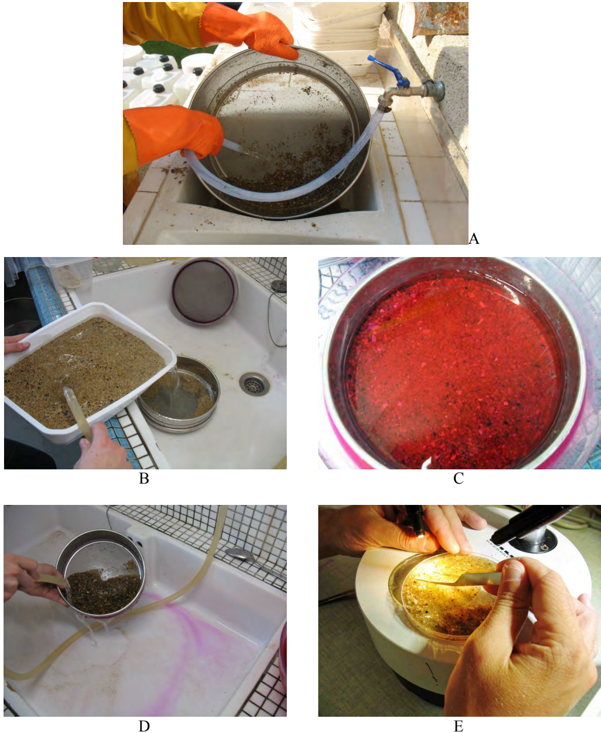
Figure 11 : Opération de rinçage des eaux de fixation puis de lavage à grande eau (A), tri hydraulique (B), coloration des refus de tamis (C) et rinçage (D) puis de tri à la loupe binoculaire des éléments les plus fins. Photos M. Chenoun, M. Sauriau & P. Cajeri CNRS ©.
