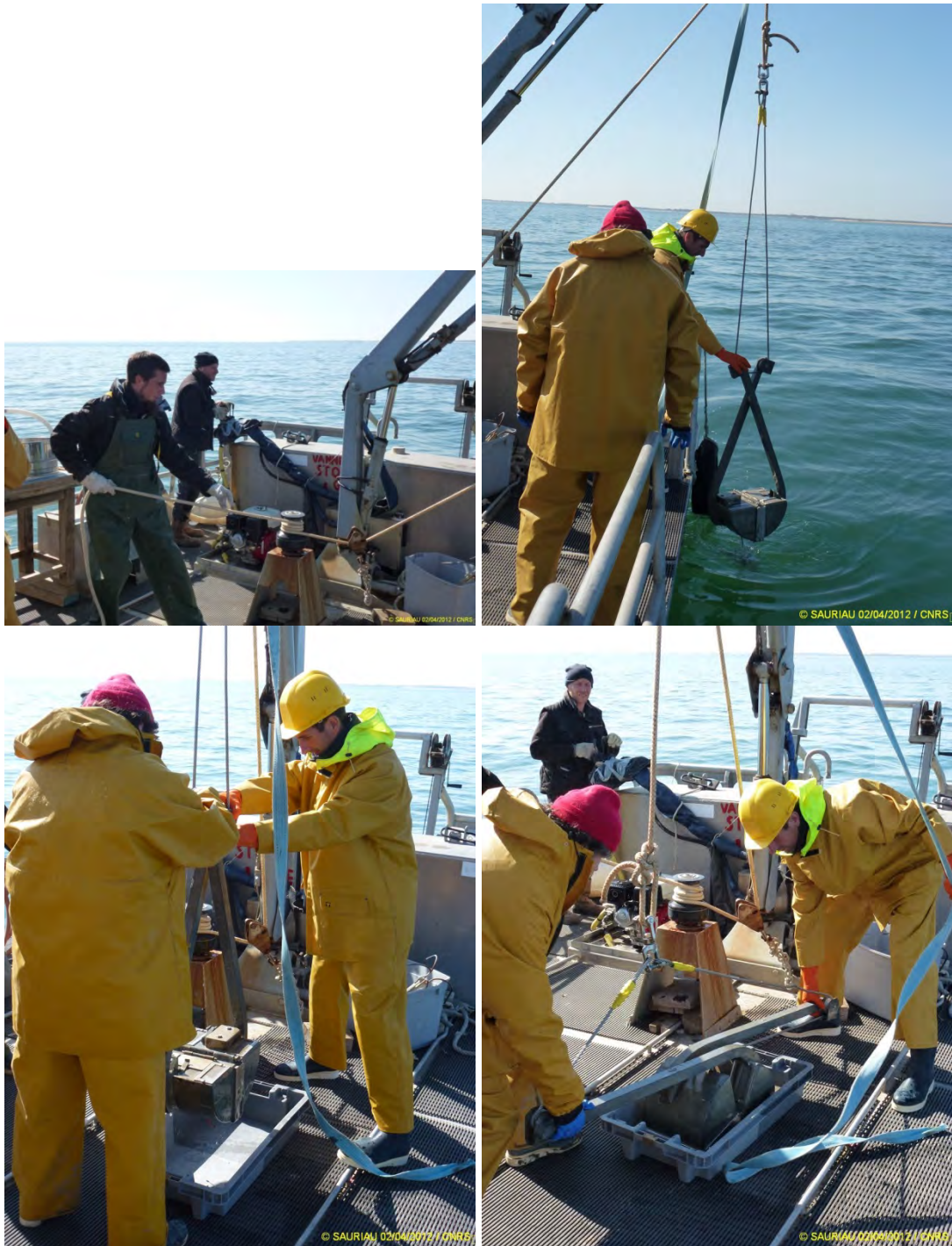
Figure 4 : Déroulement des opérations lors d'un prélèvement à la benne Van Veen. Photo P.-G. Sauriau CNRS ©
