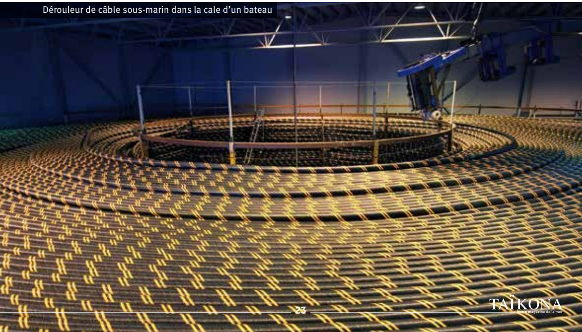
Dériveur de câble sous-marin dans la cale d'un bateau
