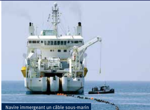
Navire immergeant un câble sous-marin
