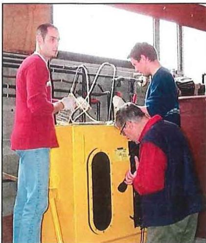
**Prélèvement de sédiment dans le ballast**
